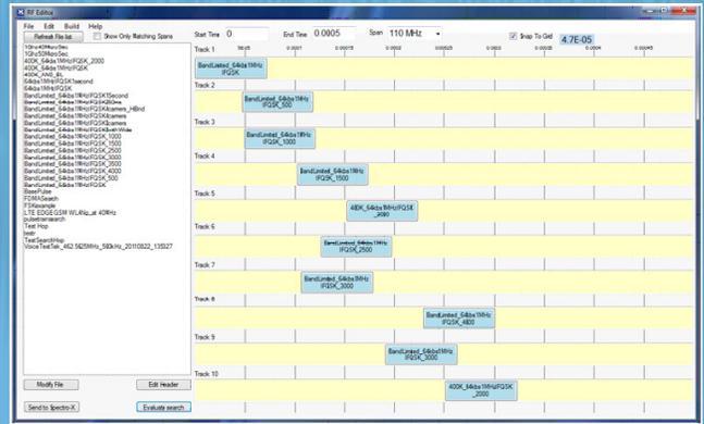
Редактор радиочастотных сигналов является инструментом графического редактирования с поддержкой перетаскивания объектов мышью, который позволяет легко изменять сигналы I&Q (находящиеся в квадратуре или имеющие фазовый сдвиг 90 градусов по отношению друг к другу) любой длины или создавать совершенно новые сигналы. Это неоценимый инструмент для модификации и построения формы сигналов во временной и частотной областях, интегрированный с программным обеспечением для анализа сигналов Spectro-X.
