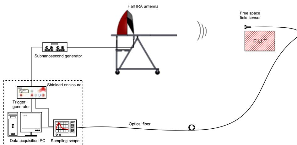
Системы для испытаний и измерений
