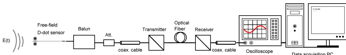
После того как все оборудование измерительной цепи установлено, программа может автоматически управлять цифровым осциллографом и обрабатывать полученные значения для отображения измеренного Е-поля, В-поля или импульсов напряжения в соответствующих единицах.
