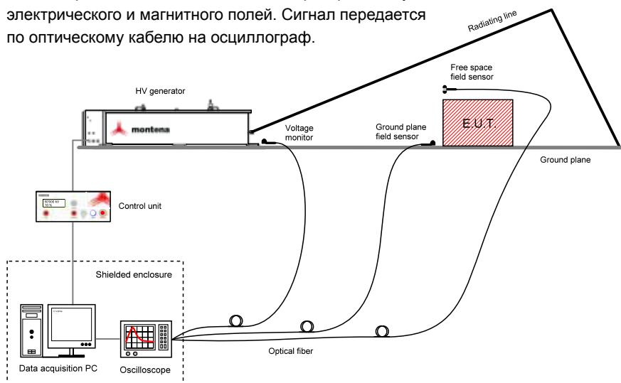
Montena поставляет целый ряд установок стандартного размера для тестируемого оборудования высотой от 50 см и выше — для крупных объектов, таких как вертолеты и самолеты. Самые компактные системы мобильны; их можно установить и свернуть менее чем за 2 часа.
